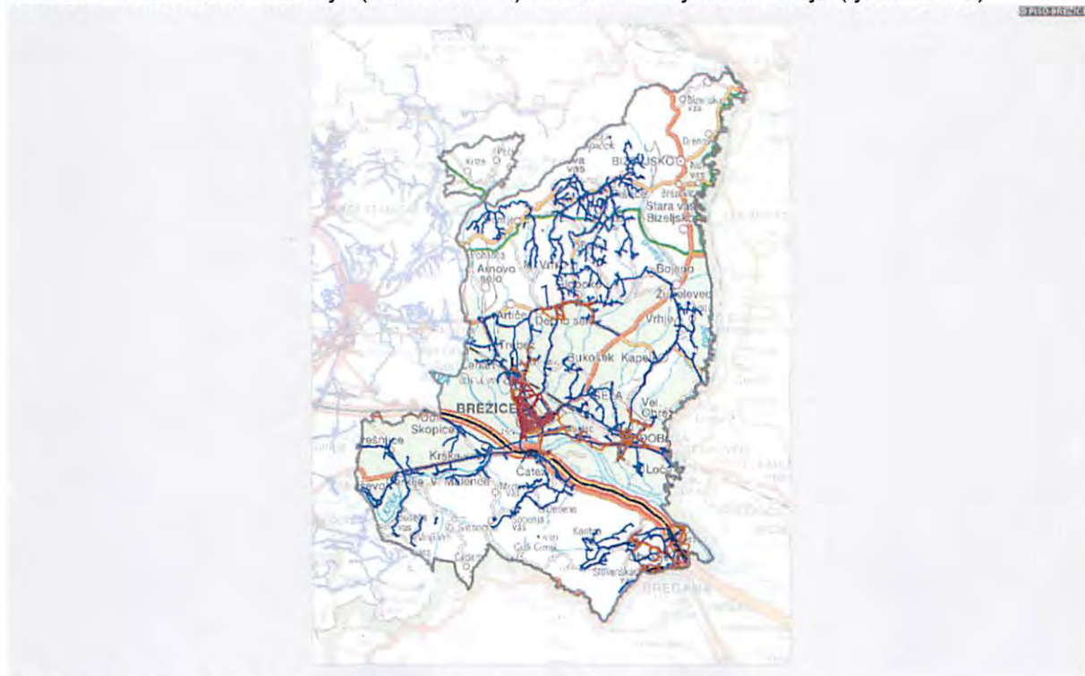
Slika 27: Vodovodno omrežje (modre barve) ter kanalizacijsko omrežje (rjave barve)
